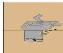
I supporti per la tenda veneziana 16-25 mm possono essere montati sia a soffitto (figura sopra) che a parete (figura sotto).
