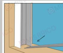
Rimuovere la protezione dell'adesivo dalla Guida a terra e posizionarla sul pavimento, prestando attenzione a metterla bene in asse rispetto alle guide laterali.
