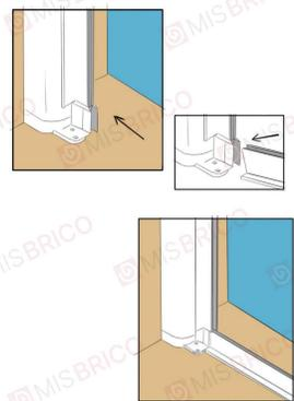
Inserire il primo cassonetto nel vano e fissare un'estremità della guida inferiore.
