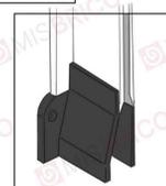
Fissare le scarpette alla base delle guide laterali.
